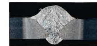
Päittäislitoksia erimuotoisilla hitsiprofileilla.
