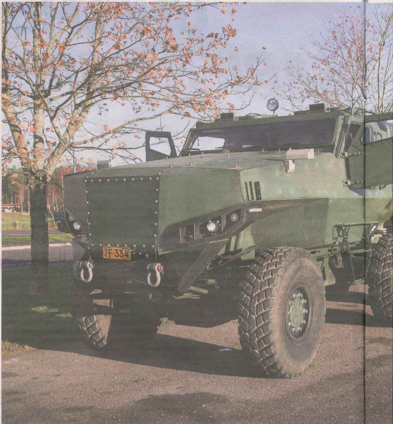
"Misu" rakennetaan niin, että se on rekisteröitävissä myös tieliikenteeseen. Sen kolmesta akselistä ensimmäinen ja viimeinen ovat ohjaavia. Ajoneuvossa on automaattivaihteisto.
