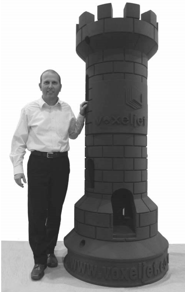
Kuva 17. Maailman suurimman tulostusalueen hiekkatulostin tulosti yhtenä kappaleena tämän hiekkatornin. Koneen malli on voxeljet VX4000, jonka tulostusalue on 4 000 mm x 2 000 mm x 1 000 mm. Koneen tuottama 600 dpi:n resoluutio takaa erinomaisen mittatarkkuuden \pm 0,3 % ja \pm 0,3 mm kappaleen koosta riippumatta. Tornin viereen mittatikuksi kuvaa varten on asettanut voxeljet AG:n CEO Dr. Ingo Ederer.
