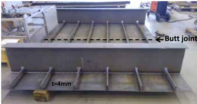
Kuva 2. Laserhybridihitsattu kansirakenne ja siitä leikatut koekappaleet väsytyскоestukseen.
