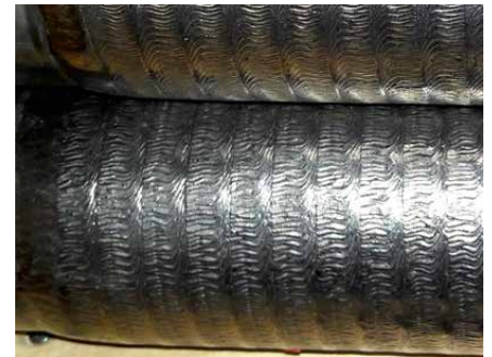
Kuva 1. Erytyypisiä hitsauspinnoitteita: ylhäällä putkipaneelin pituussuuntainen hitsauspinnoite ja alhaalla erillisen putken spiraalimainen pinnoite.
