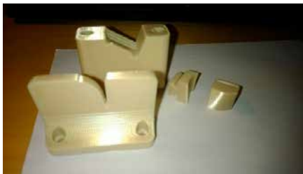
Kuva 8. Tulostetut paikoitusteline ja tarttujan insertit, robottitarttujat ja turbiinin siipi.
