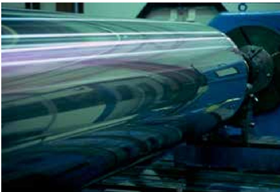
Kuva 4. Pinnoitettu kalanteritelan pinta pinnoituksen ja hionnan jälkeen. Lähde: Valmet Technologies.
