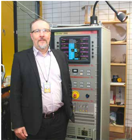
Prof Jukka Kömi ja Oulun yliopiston terästutkimuksen avainresurssin, GLEEBLE -laitteiston ohjauspaneeli.
