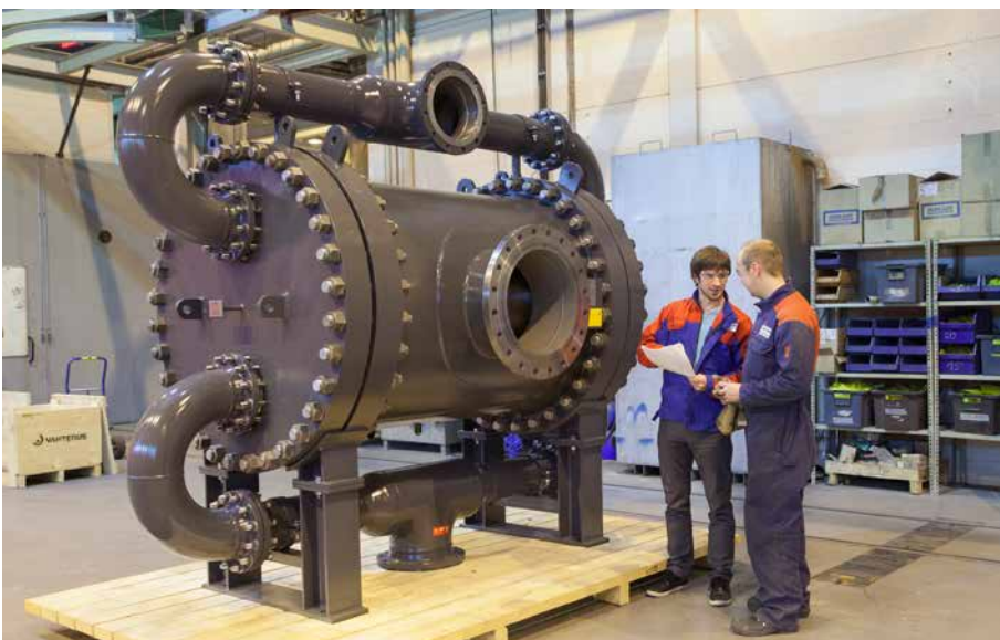
Kuva 18. Täystitaaninen levylämmönsiirrin (Vahterus Oy).
