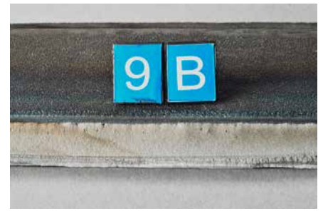
Kuva 6. S235 hitseissä oli hyvä tunkeuma ja ne olivat muutenkin laadukkaita.
