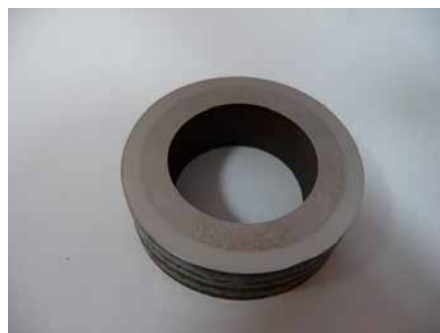
Kuva 2. Putkinäyte ja Inconel 52 -hitsauspinnoitteen poikkileikkaus.
