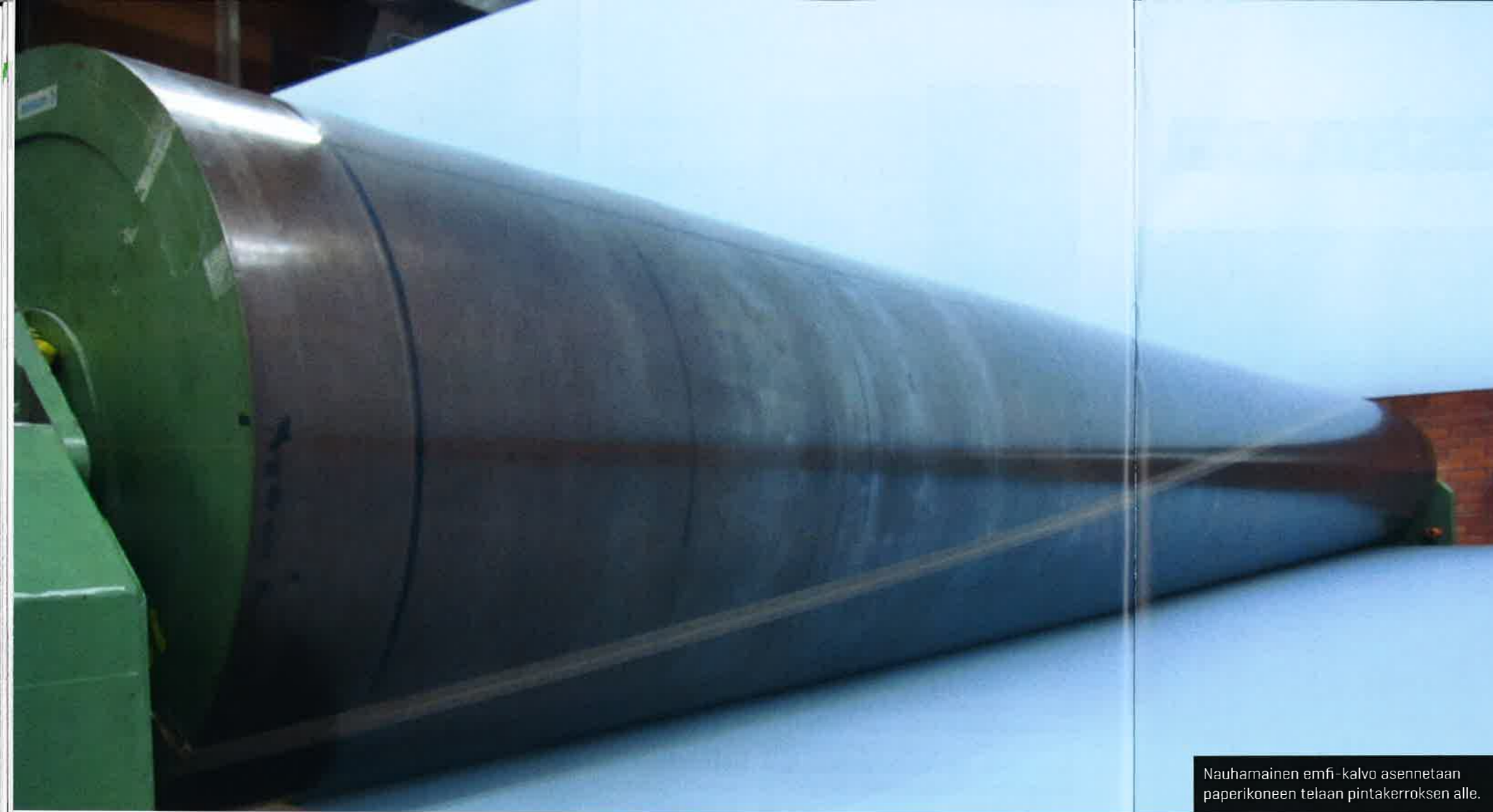
Kun emfi-kalvo asennetaan spiraaliin muotoon, anturit kattavat koko telan pinta-alan.
