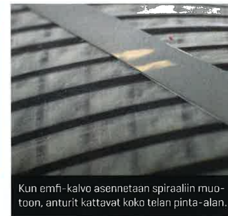
Emfi-anturikalvoa valmistetaan helppokäyttöisenä rullatavarana.
