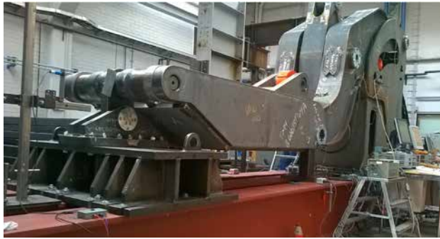
Kuva 2. Prototyypipuomin FE-mallilla simuloidut jännitykset väsytyksessä (vas.) ja puomin täyden mittakaavan väsytyksokijärjestely LUT Teräsrakenteiden laboratoriossa (oik.).
